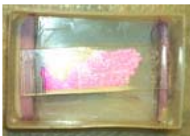
Fig. 11: Il portaoggetti posto sui supporti nella vaschetta per la colorazione di Giemsa. Lo striscio, già colorato con il May-Grünwald, è posto sul lato inferiore del vetrino, in modo che, quando la vaschetta verrà riempita con il colorante, questo non possa lasciare depositi sul preparato.
