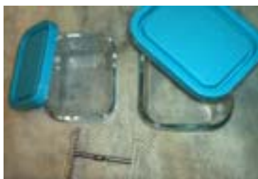
Fig. 19 (a sinistra): vaschette per colorazione di tipo... "domestico" con rastrelliera portavetrini.
