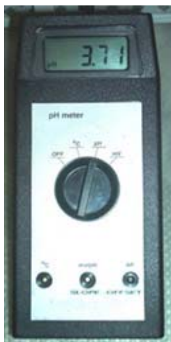
Fig. 13: pH-metro da laboratorio
