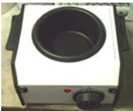
Fig. 1 (sopra): Bagnomaria elettrico per fondere la paraffina.
