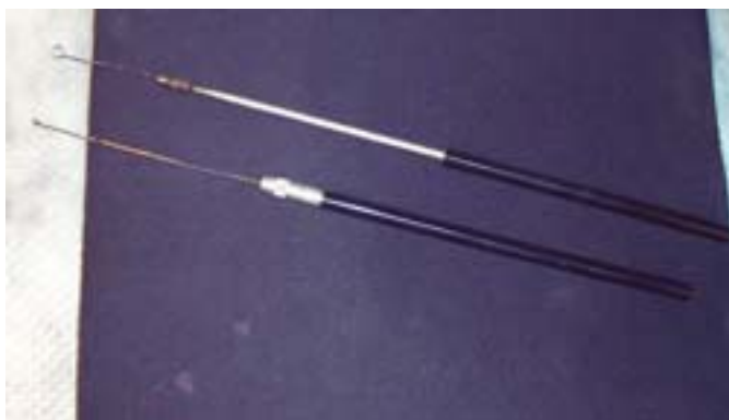
Fig. 17 : Anse di platino per microbiologia: quella superiore ha una “capacità” di 5 \mu l; quella inferiore ha una “capacità” di 1 \mu l.
