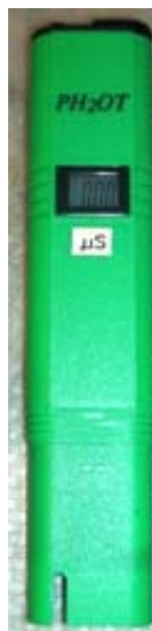
Fig.14:conduttimetro per acqua distillata
