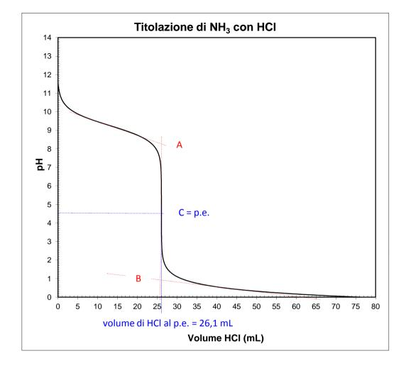
Il punto equivalente (p.e.) della titolazione si trova nel tratto di curva in cui si verifica una grande variazione di pH per una piccola aggiunta della soluzione contenuta in buretta.
